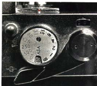
En lille arm, hvor kassetten ind sættes, sørger for, at der kun bruges strøm til lysmåleren, når der er film i kameraet.
