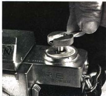
Tilbagespolingsknappen har håndsving og glider selv op, når den drejes.
